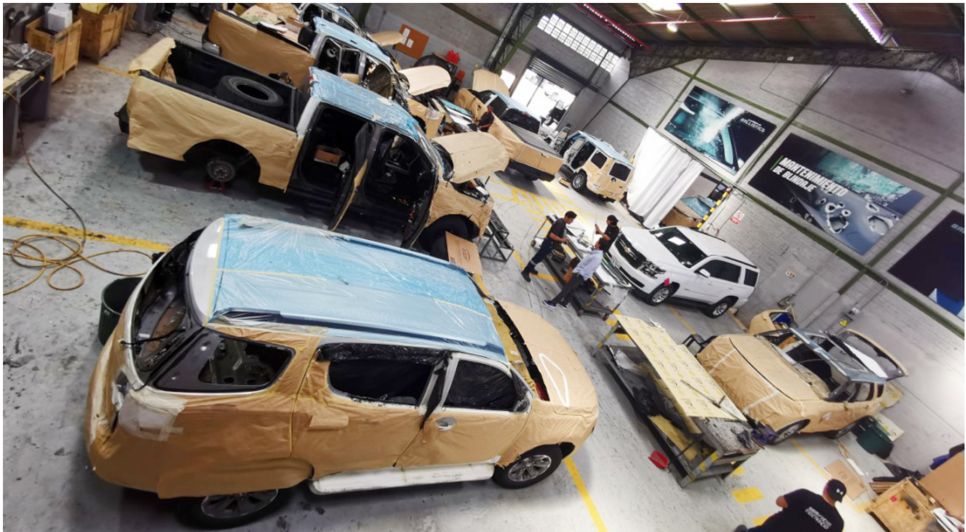
• Todo el vehículo se desarma y la carrocería se cubre con tejido antibala kevlar y refuerzos de acero en el proceso de blindaje.
